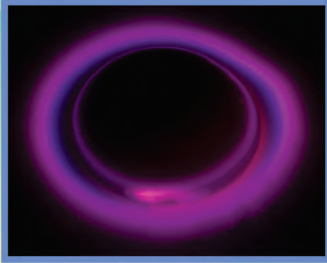
आइपीआर आउटरीच प्रभाग द्वारा विकसित टेरेला डिवाइस की प्रारंभिक छवियां। ( बाएं ) एक ओर का चित्र ( दाएं ) चुंबक के साथ हॉलो स्फियर की भूमध्य रेखा के चारों ओर रिंग करंट का ऊपरी दृश्य Preliminary images of the Terrella Device developed by IPR Outreach Division. (L) Side View (R) Top View of the ring current around the equatorial line of a hollow sphere with a magnet
