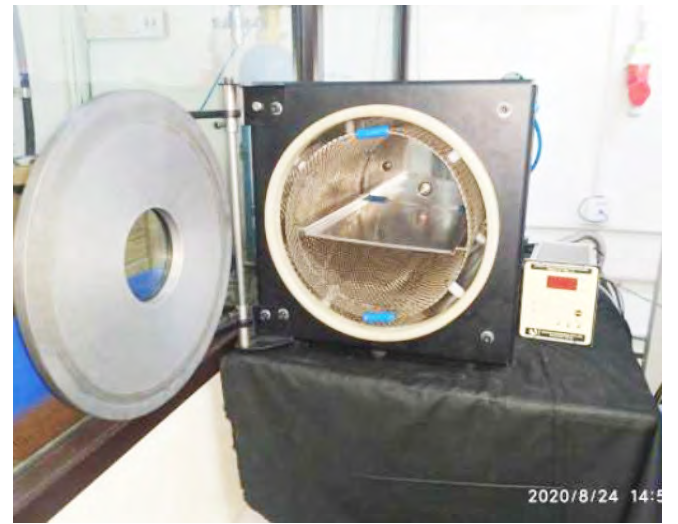
चित्र A.1.5 कॉम्पैक्ट, ग्लो स्चार्ज आधारित प्लाज़्मा स्टेरलाइज़र
