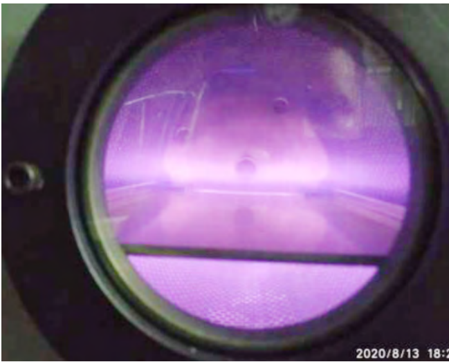
चित्र A.1.5 कॉम्पैक्ट, ग्लो स्चार्ज आधारित प्लाज़्मा स्टेरलाइज़र
