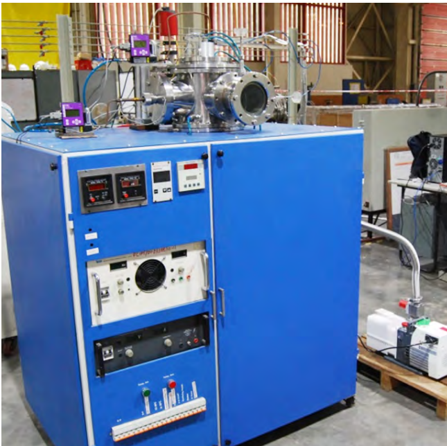
चित्र A.4.2.1 उच्च तापमान प्रतिक्रियाशील मैग्नेट्रॉन स्पटर कोटिंग सिस्टम आंतरिक रूप से विकसित किया गया।
