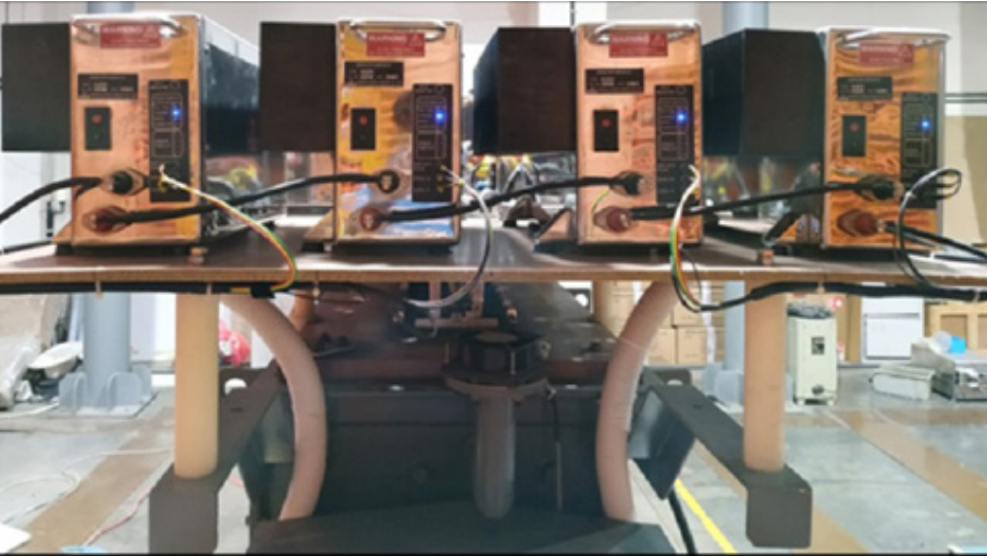
चित्र B.8 (a) प्रयोगशाला में संस्थापित आरआईडीपीएस एसपीएस मॉड्यूल्स (b) आरआईडीपीएस नियंत्रक
