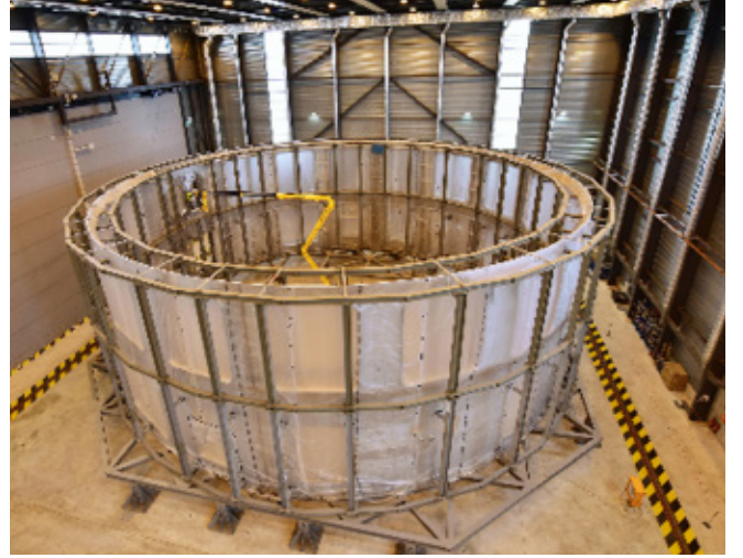
चित्र B.1 इटर साइट पर वर्कशॉप में क्रायोस्टेट लोअर सिलेंडर पूर्ण किया गया
