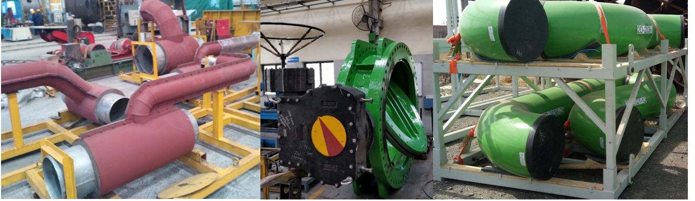
चित्र B.2 जल शीतलन प्रणाली के हिस्से (a) पाइप स्पूल्स (b) वाल्व एवं (c) पाइप स्पूल्स
