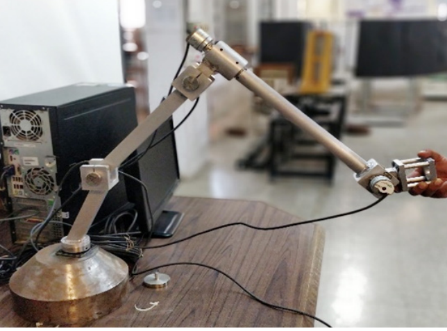
चित्र A.2.6.1 मैनिपुलेटर के नियंत्रण के लिए प्रोटोटाइप मास्टर आर्म A.2.6 रिमोट हैंडलिंग और रोबोटिक्स टेक्नोलॉजी
