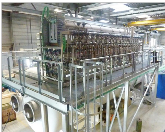
चित्र B.4 मैकेनिकल फैक्ट्री स्वीकृति परीक्षण (एफएटी) के लिए फैक्ट्री में सीटीसीबी
