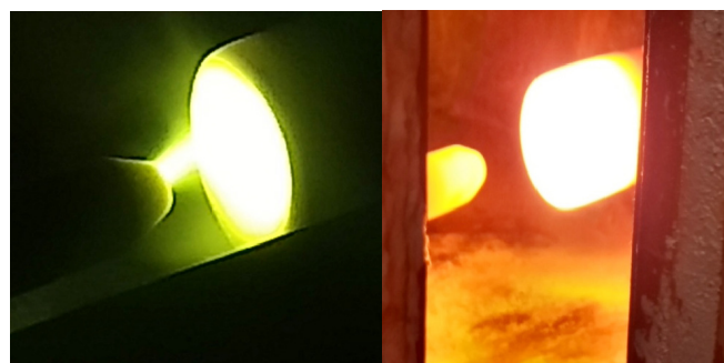
चित्र A.3.6 (a) प्रचालन के दौरान प्लाज़्मा टॉर्च यूवी स्क्रीन द्वारा देखी गई (b) प्रचालन के तुरंत बाद गरम लाल ग्रेफाइट इलेक्ट्रोड
