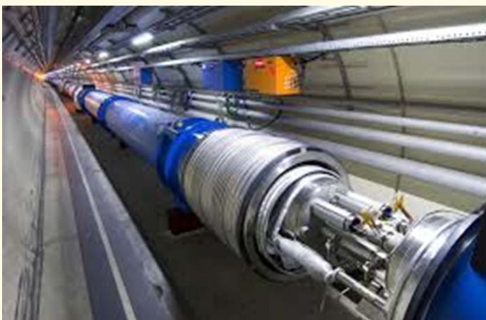
चित्र 8: लार्ज हैड्रॉन कोलाइडर, एलएचसी(LHC), सी ई आर एन(CERN) में सुपरकंडक्टर्स का उपयोग (पार्टिकल एक्सलेरेटर में सुपरकंडक्टिविटी)
