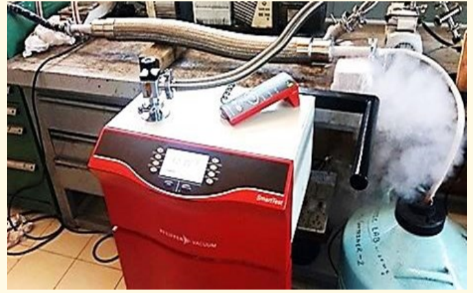
चित्र सं 13 - 77 केल्विन पर हीलियम लीक टाइटनेस परीक्षण
