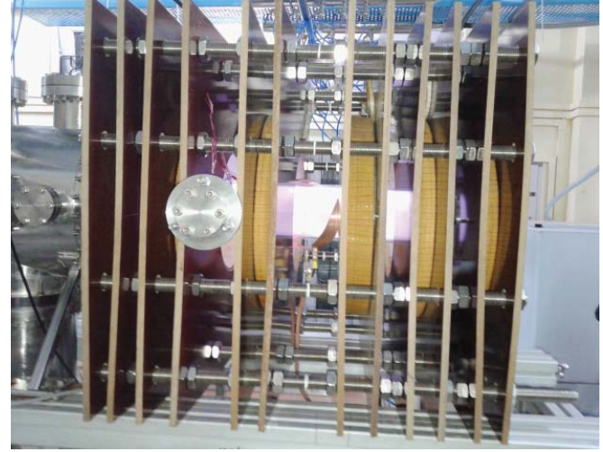
चित्र A.1.8 HeliPS प्रणाली में उत्पादित आर्गन प्लाज़्मा
