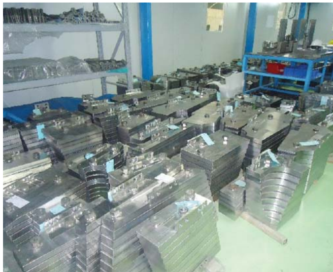
चित्र B.1 भीतरी-दीवार परिरक्षण ब्लॉक असेम्बलियाँ - निर्मित एवं परीक्षण के तैयार की जा रही हैं
