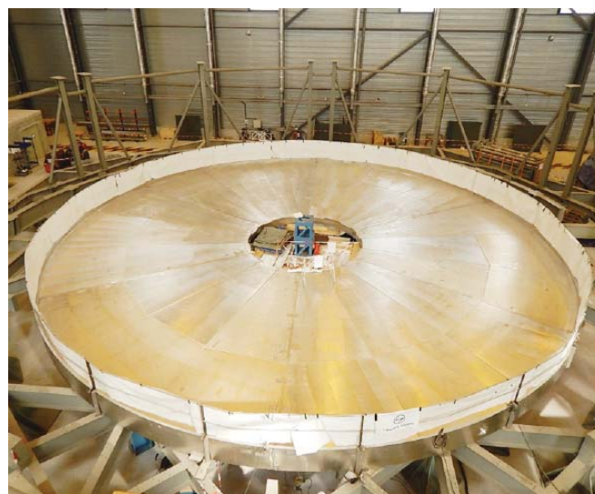
चित्र B.2 इटरसाइट वर्कशॉप में क्रायोस्टेट बेस सेक्शन टियर-1 वेल्डिंग एवं परीक्षण
