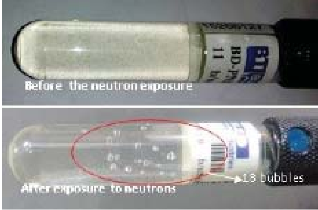
चित्र A.1.7 बबल संसूचक का इस्तेमाल करके आईईसीएफ युक्ति से न्यूट्रॉनों का संसूचन
