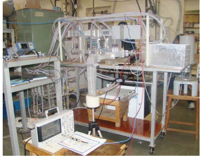
चित्र A.1.3 स्पंदित मॉड्युलेटर एवं एचपीएम युग्मन घटक के साथ एकीकृत मैग्नेट्रॉन प्रणाली
