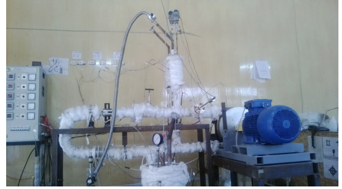
चित्र A.2.4.3 लूप नैदानिकी के परीक्षण के लिए लेड-लिथियम लूप
