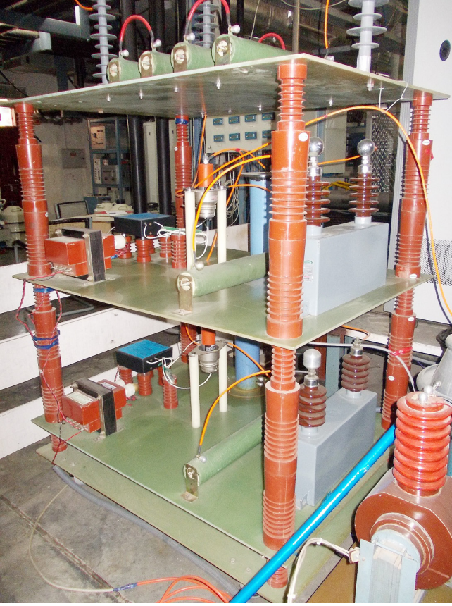
A.1.2.6 70kV इग्निट्रॉन क्रोबार प्रणाली
