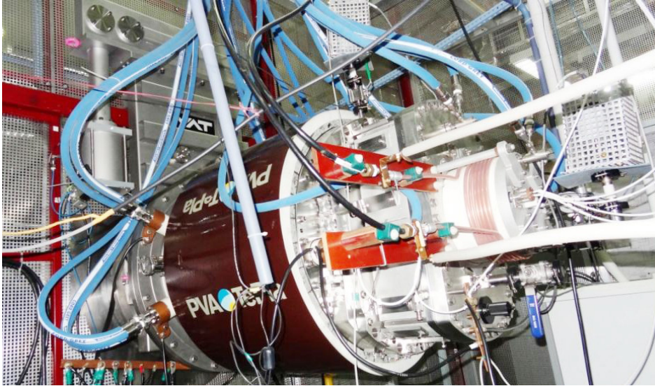
चित्र A.2.7.1. संयोजित निष्कर्षण प्रणाली के साथ ऋणात्मक आयन स्रोत परीक्षण तल, रॉबिन
