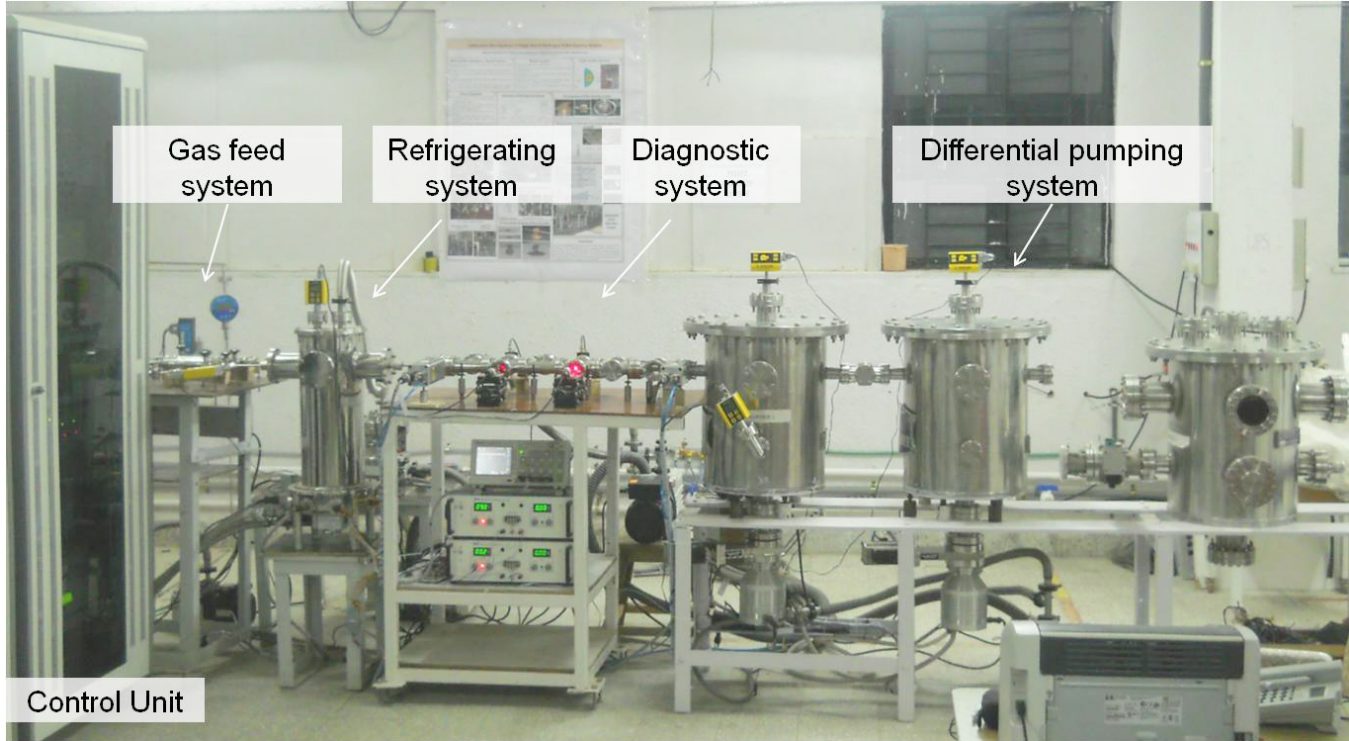
चित्र A.2.3.3. एकल गुटिका अंतःक्षेपक प्रणाली (एसपीआईएनएस)
