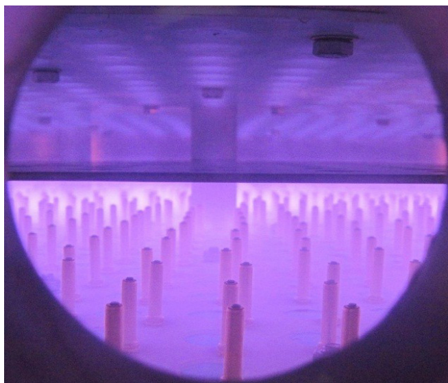
चित्र B.1.2 यह चित्र प्लाज़्मा में उपचारित हो रहे पीतल वाल्व को दर्शाता है।
