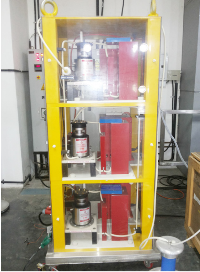
चित्र B.2.5. इग्नोट्रॉन आधारित क्रोबार संरक्षण प्रणाली
