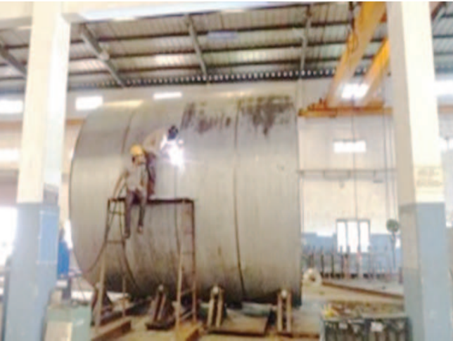
चित्र 2.7.1 वेंडर के स्थान पर आईएनटीएफ पात्र के विभिन्न भागों का निर्माण
