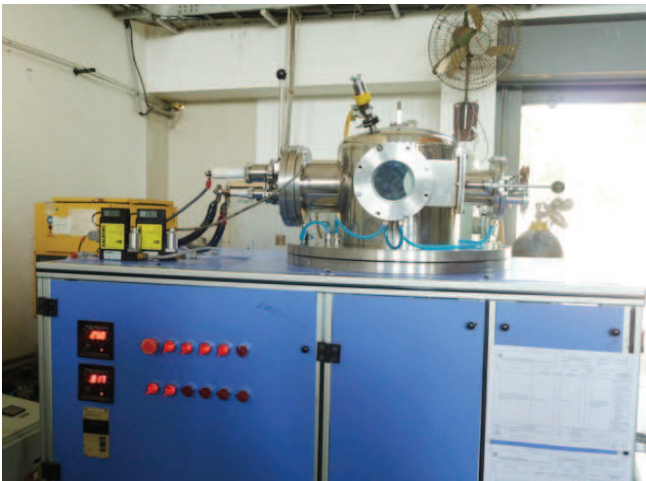
चित्र-B.1.2 एफसीआईपीटी में विकसित प्लाज़्मा कार्बुराइजिंग प्रणाली
