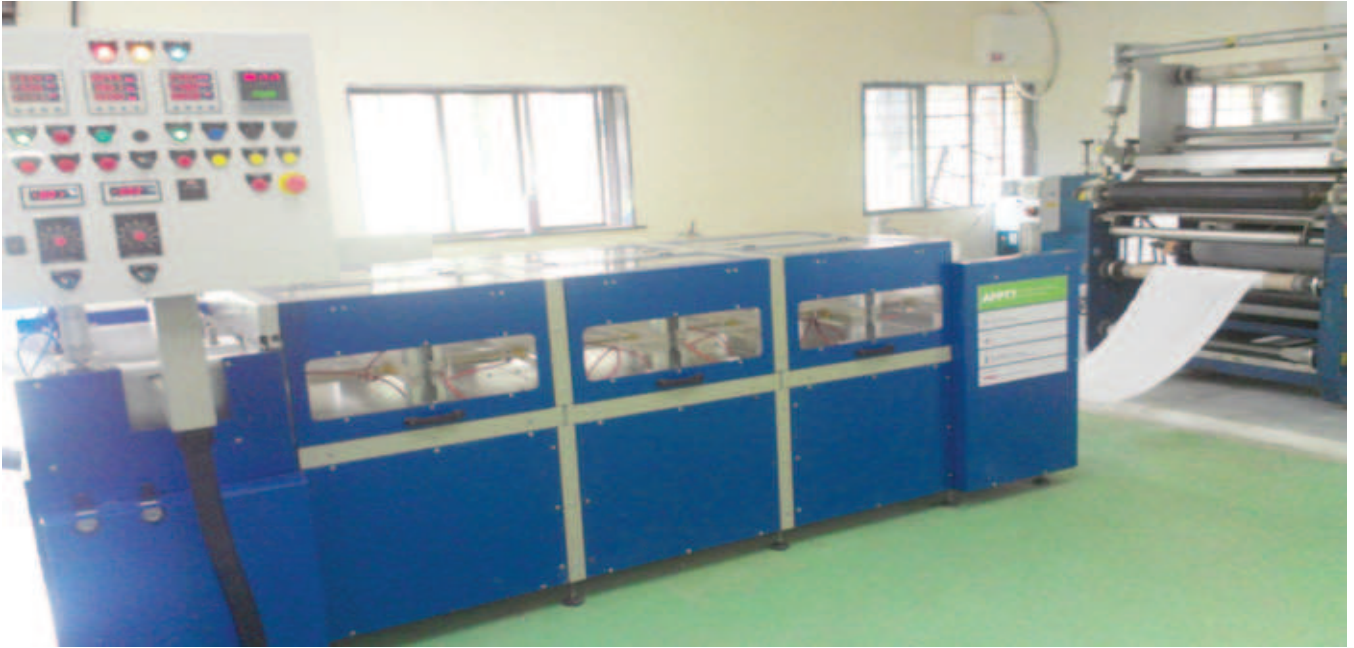
चित्र-B.1.1 कपड़ा उपचार के लिए एफसीआईपीटी, आईपीआर द्वारा विकसित प्लाज़्मा रिएक्टर तथा मंत्रा, सूरत में कार्यरत
