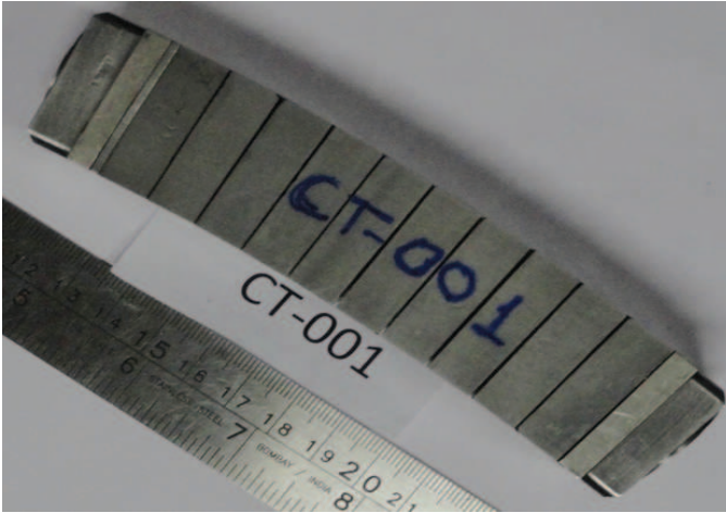
चित्र A.2.2.2 (a) घुमावदार टंगस्टन मोनो-ब्लॉक
