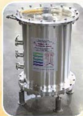
अगस्त्य - 400 : देश में विकसित क्रायोसॉर्प्शन क्रायोपम्प AGASTYA-400: Indigenously developed Cryosorption Cryopump
