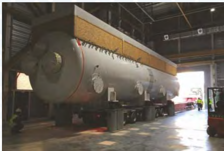
क्रायो-प्लांट टर्मिनेशन कोल्ड बॉक्स (CTCB)
