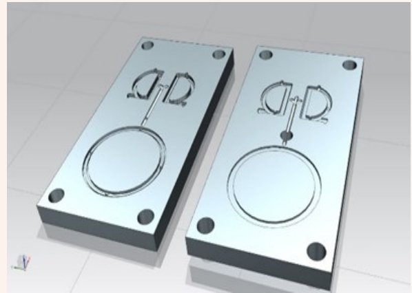
चित्र 5b: पामटॉप टोकामॅक मॉडल के कॉइल्स के डाई का सीएडी मॉडल
