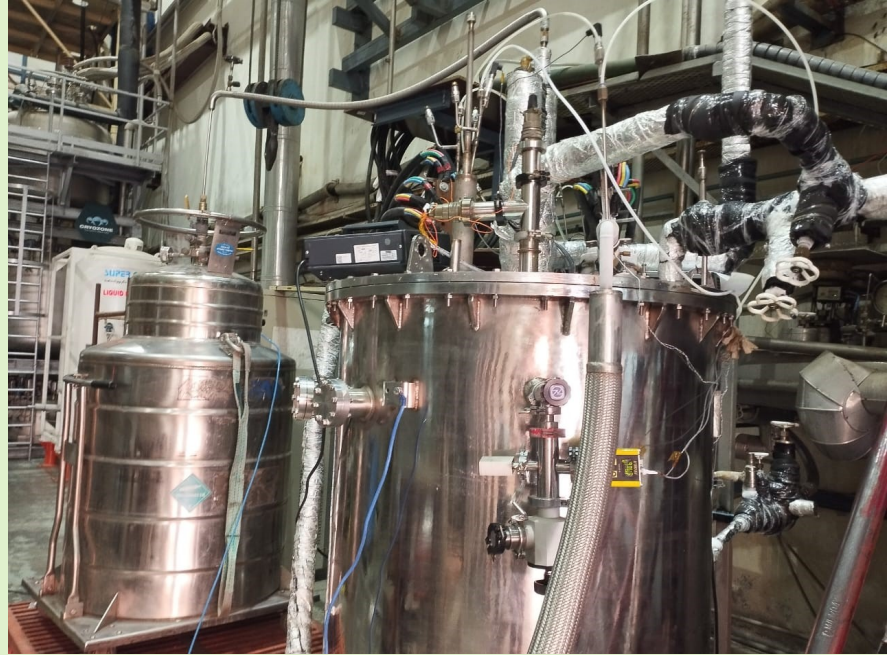
एचटीएस सीएल परीक्षण क्रायोस्टेट परीक्षण असेंबली से जुड़े तरल हीलियम देवार के साथ आवश्यक उपकरणों से सुसज्जित है।
