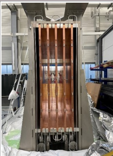
चित्र 1: 3 मीटर लम्बा, 1.8 मीटर ऊँचा, 17 टन वजन और 5 पैनल का DNB अनावेशक। इसके प्रत्येक पैनल में 1 m लम्बे उप-पैनल हैं जिन्हें CuOF से बनाया गया है। पैनलों को क्षैतिज एवं ऊर्ध्व दिशा में गहरे खोदे हुए सर्पिलाकार जलवाहिकाओं द्वारा शीतल किया जाता है। CuOF-Ni-SS में शीतल जल परिवहन में होने वाले परिवर्तन के लिए EBW का व्यापक प्रयोग किया गया है जिससे खुले भागों को बैंड रखा जा सके (ऊपर से नीचे प्रवाह की दिशा का द्रश्य)
