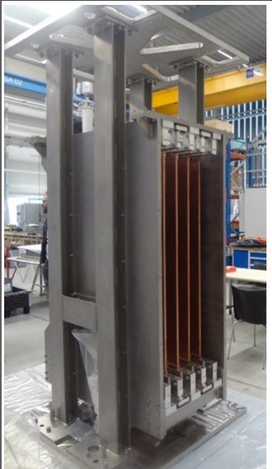
चित्र 2: 1 मीटर लम्बा, 1.8 मीटर ऊँचा, 5 टन का अवशेषित आयन संग्राहक, जिसमें CuCrZr के 50 जल शीतलित घटक जिसके द्वारा किरण में आने वाले आवेशित घटकों को अनावेशित घटकों से प्रथक किया जा सके। समन्वयोजन में एक के बाद दूसरे पैनल को उच्च वोल्टता और भू-विभव पर रखा गया है।
