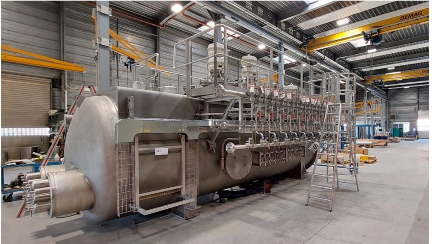
चित्र कारखाने की स्वीकृति परीक्षण के दौरान कार्यशाला में थर्मल शील्ड कोल्ड वाल्व बॉक्स दिखाता है
