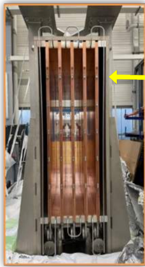
17 टन का, 2 मीटर ऊंचा और 1 मीटर चौड़ा 5 चैनल अनावेशक
