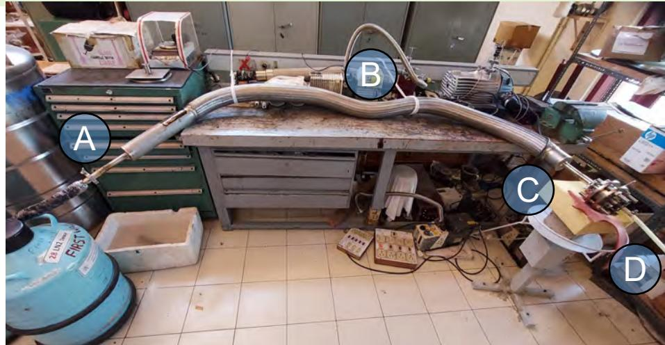
(बाएं) नॉन रिटर्न वाल्व समायोजन के साथ ट्रांसफर लाइन का प्रदर्शन परीक्षण (A) LN<sub>2</sub> इनलोट (B) ट्रांसफर लाइन (C) वाल्व असेंबली (D) LN<sub>2</sub> आउटलेट (दाएं) सिरस्टम की मुख्य विशेषताएं
