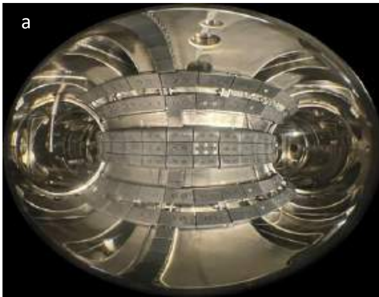
आदित्य-यू टोकामक का टोरोइडल-पोलोइडल दृश्य (चित्र a), जिसमें स्थापित डाइवर्टर प्लेटों के साथ टोरोइडल बेल्ट लिमिटर प्रदर्शित हैं; तथा फ्लश लैंगमुइर प्रोब (चित्र b) को लाल वृत्त द्वारा दर्शाया गया है।
