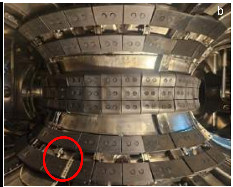
आदित्य-यू टोकामक का टोरोइडल-पोलोइडल दृश्य (चित्र a), जिसमें स्थापित डाइवर्टर प्लेटों के साथ टोरोइडल बेल्ट लिमिटर प्रदर्शित हैं; तथा फ्लश लैंगमुइर प्रोब (चित्र b) को लाल वृत्त द्वारा दर्शाया गया है।
