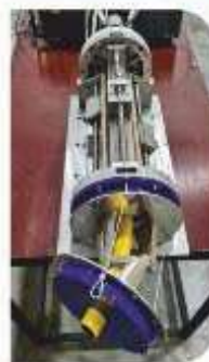
लेस बंडल को संचालित करने के लिए मैनिपुलेटर का प्रोटोटाइप Prototype manipulator for maneuvering the lens bundle
