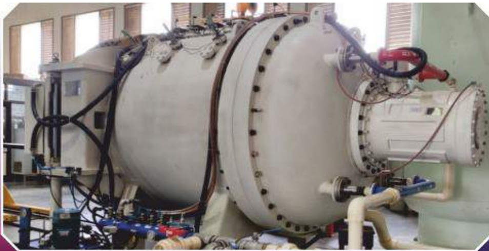
प्लाज़्मा कार्बुराइजिंग प्रणाली Plasma carburizing system
